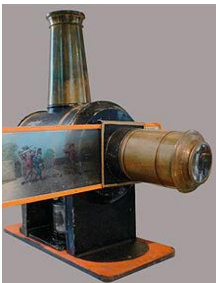
La lanterne magique est formée de trois éléments : une source lumineuse, une plaque de verre peinte et un objectif (une lentille convergente). Elle fonctionne sur le principe de la chambre noire, où la source lumineuse (soleil) et les images projetées (paysages) sont remplacées par des éléments artificiels (lampe et plaque de verre peinte). La lumière passe par la plaque de verre, puis par la lentille, pour projeter l'image renversée (haut-bas) peinte sur la plaque.
